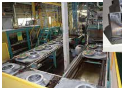
石膏型製作ライン(鍛造法)
