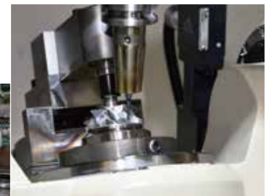
5軸MCによる削出(削出法)
