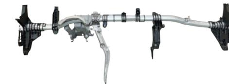
軽量化のために異種素材を組み合わせているステアリング・ハンガーの例。アルミ合金と樹脂、マグネシウム合金が使われている。
