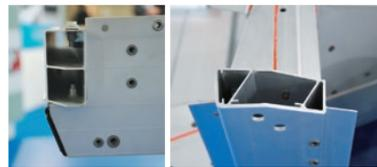
使われているのは6060番のアルミ合金押出材で、使われる部分により断面形状を変えているのがよくわかる。こういう形状を実現できるのが押出加工の特徴だ。写真で赤く見えるのは接着剤。ロータスはアルミ合金シャシーで接着剤を多用する。
