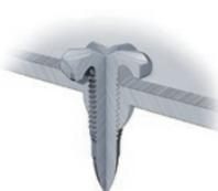
いわゆるねじ留め的一种。母材には穴を開けておく必要があるが、ねじ留めのため、締結部分を再び外すことができるのも利点である。
