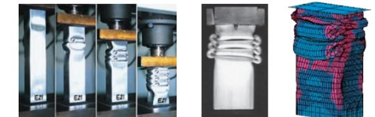
衝突時にクラッシュボックスに付加される圧縮荷重により、クラッシュボックスが圧壊する過程を実験とCAEによる解析で比較したグラフ。実験値と解析値が一致していることがわかる。
