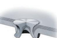
2枚以上の板材を締結させる手段で、リベットの脚部を母材に食い込ませ、変形させることで抜けにくい構造とする。あらかじめ穴を開ける必要がないため強度低下しない。
