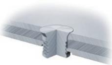
穴の開いていない2枚の板材に対してくさび状の円柱部材を強制的に押し込み締結する。加工面がフラットになるため、ルーフやピラー周りで用いられる。
