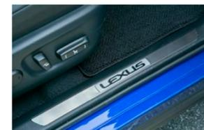
スカッフプレートは、デザインと傷つき防止の機能性を併せもった意匠性アルミ合金製。
