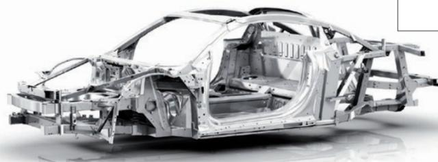
テーラードブランクを最初に市販車に採用したのがアウディR8(初代)。フロアパネルのセンタートンネル部分だ。
