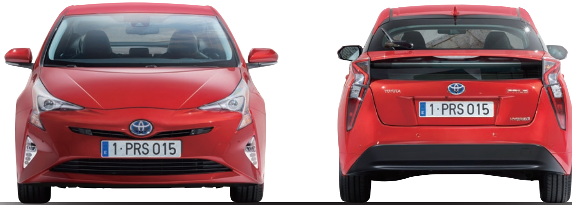
2015年にデビューしたトヨタの4代目プリウスは、世界最高水準の燃費性能を持つ世界最量販ハイブリッド車だ。TNGAという新世代モジュラープラットフォームを採用した新型プリウスは、3代目と同様に、ボンネットフードとリヤゲートがアルミ合金製だ。いわゆる「ふた物」と呼ばれるパーツだが、アルミ合金化による軽量化の恩恵は大きい。
