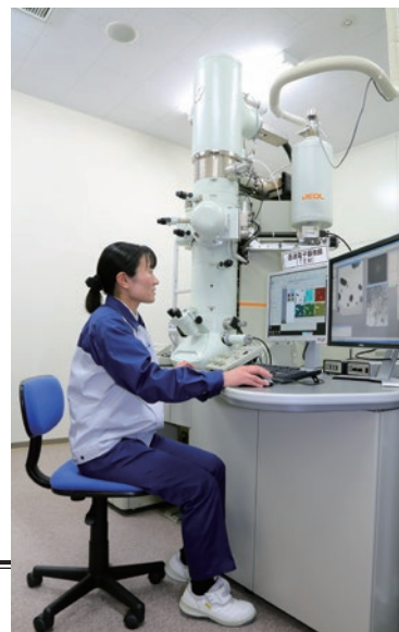
アルミ材料を電界放射型透過電子顕微鏡 (FE-TEM) を使って結晶構造を観察・分析していた。金属材料の微細組織をナノスケールで制御する取り組みだ。(深谷センター)
