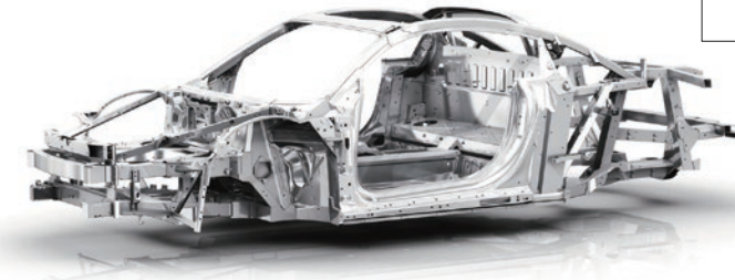
テーラードブランクを最初に市販車に採用したのがアウディR8(初代)。フロアパネルのセンタートンネル部分だ。
