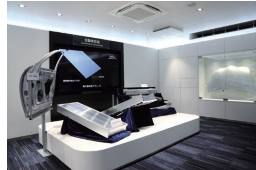
オープンイノベーションを志向し広いスペースが用意されていた自動車技術コーナー。ボンネットフード、バンパーレインフォース、フロントドアなどが並ぶ。中央にはパワートレインの電動化に向けたバッテリーハウジング(試作品)を展示。
