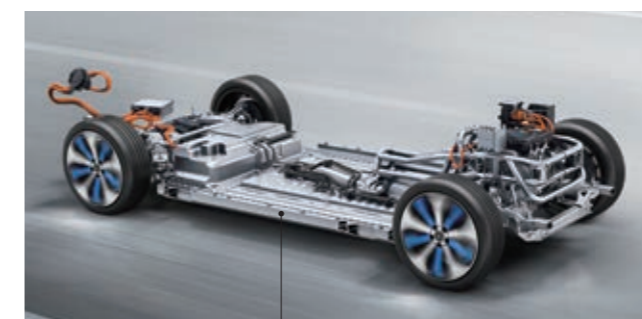
メルセデス・ベンツEQC サイドインパクトプロテクション構造(アルミ押出型材)
