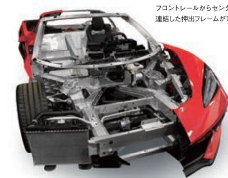
フロントレールからセントラートンネル部に連結した押出フレームが車体の中央を走る。
