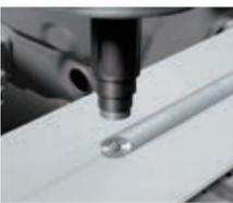
FSW（摩擦攪拌接合）は、先端に突起のある円筒状工具を回転させながら部材に貫入し摩擦熱により母材を軟化させ、接合部周辺の塑性流動により練り混ぜる接合法。歪みや残留応力が少ないなどメリットが多い。
