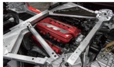
ショックタワー部分の大型のアルミ鋳造品を、アルミ押出型材のクロスメンバー、ブレース類が支える。
