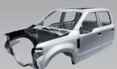
オールアルミ・モノコックボディ > FORD F-150 Lightning
