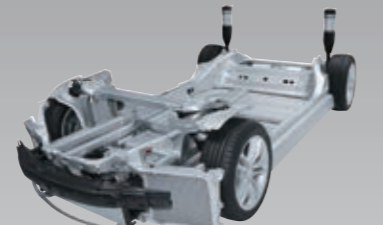
オールアルミ合金プラットフォーム > TESLA MODEL S
