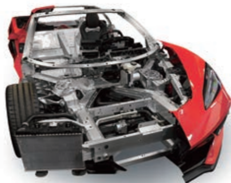
シボレー コルベット C8 アルミ合金スペースフレーム
