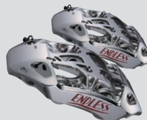
車両の大型化や高性能化が進む中で、軽量かつ高剛性の鍛造部品に対する需要が高まっています。アルミニウム鍛造ブレーキキャリアは、優れた性能を発揮しながら、ブレーキング時に発生する過酷な高温環境に耐える必要があります。このキャリアは、ナノレベルで金属組織を制御し、航空宇宙グレードの熱処理を施した高温時高強度の鍛造用アルミ合金で製造されており、優れた強度と耐熱性を実現しています。また、軽量化により、走行性能の向上にも貢献します。
