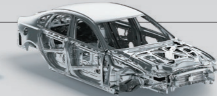
All-aluminum alloy monocoque | Jaguar XE
