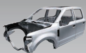
All-aluminum monocoque body > FORD F-150 Lightning
